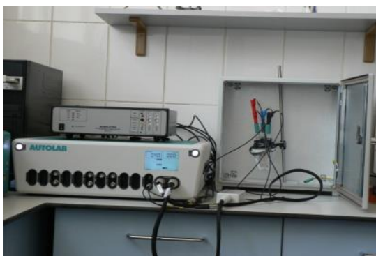
Fig. 2.16. Celula electrochimica folosita la depunerea filmelor de PPy si potențiostatul Autolab PGSTAT 302 N
