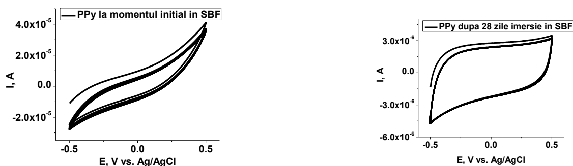
Fig. 2.20. Voltamogramele ciclice obtinute la timpul initial de imersie si dupa 28 zile imersie in SBF pentru Ti6Al7Nb/PPy, -0.5 \div 0.5 V, 0.05 V/sec, 10 cicluri.
